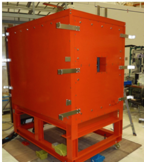
図 2.12 鉛遮蔽の写真。厚さは 5-10 cm である。
